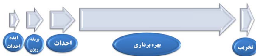
شکل ۳: در نظر گرفته شدن تمام مراحل چرخه عمر یک مجموعه در مهندسی و مدیریت ساختارها و تجهیزات
